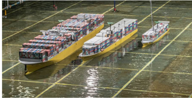
De drie geteste containerschepen op schaal 1:63 in het MARIN Offshore Basin
